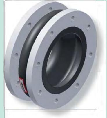
**Balgaufbau** Hochgewellter Gummibal mit Träger-einlagen und angeformtem Dichtwulst mit Kernring, selbstdichtend (keine Zusatzdichtungen erforderlich). Geeignet zur Aufnahme von drehbaren Flanschen.
