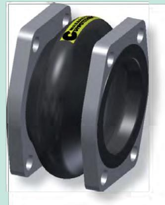
**Balgaufbau** Hochgewellter Gummibal mit Trägereinlagen und angeformtem Dichtwulst mit Kernring, selbstdichtend (keine Zusatzdichtungen erforderlich). Geeignet zur Aufnahme von drehbaren Flanschen.
