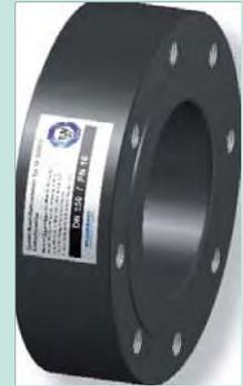
**Balgaufbau** Zylindrischer, glatter Gummikörper **Flanschausführung** Einvulkanisierte Flansche aus Stahl mit einvulkanisierten Flanschringen. mit Gewinde-Sacklöchern, gebohrt Der Gummi-Metall-Rohrverbinder nach DIN PN 6 oder 10 (Standard). ist selbstdichtend (keine Zusatzdichtungen erforderlich).
