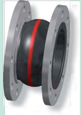
Zum Einsatz kommt der Typ 39 z. B. im Anlagenbau und in der Wasser- und Abwassertechnik. Hier wird er speziell im Reparaturfall eingesetzt, wenn die entstandene Baulücke keiner Standardbaulänge entspricht. So können teure Umbauarbeiten am Leitungssystem vermieden werden. Er wirkt geräuschkämpfend und nimmt Schwingungen auf.
